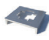
Шаблон для установки креплений балясин
